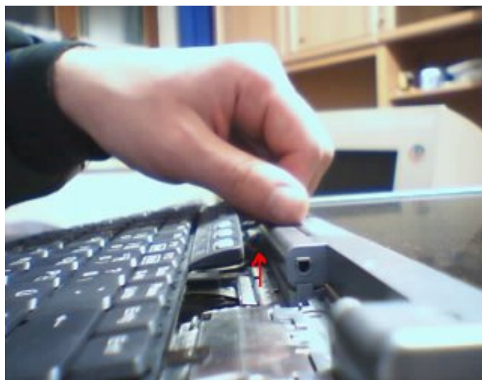
(Abbildung 4: Anheben der Tastatur)
